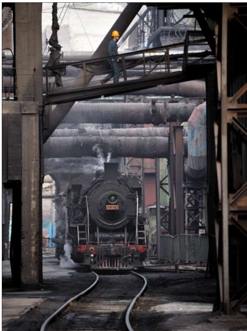
▲ Nur durch zum Teil enge und abenteuerliche Gleisführung kommen die Dampflokomotiven der Baureihe SY in jeden noch so versteckten Winkel des Stahlwerkes in Beitai.
